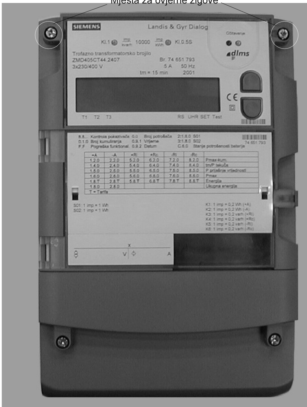
Slika 1. Izgled trofaznoga statičkog brojila tip ZMD 405 CT s označenim mjestima za žigosanje
